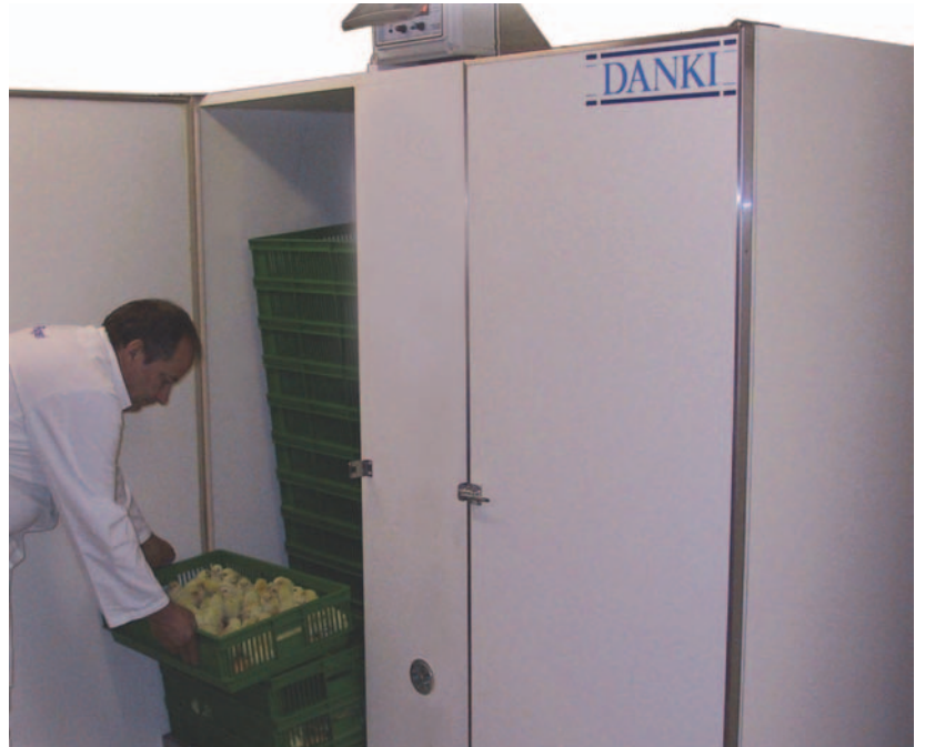
Nacedora mod.3/3400 Capacidad 3328 huevos de gallina.
